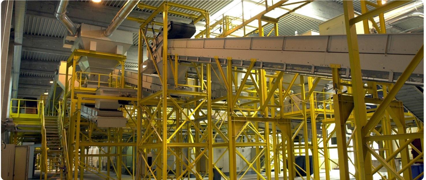
FHF Gleitgurtförderer Typ PL werden vorwiegend für den Transport von leichten Wertstoffen wie Folien, Tetra, Papier, PET und ähnlich leichten Wertstoffen verwendet, wo es auf eine gleichmäßige Verteilung auf dem Förderband ankommt. Daher wird dieser Förderer häufig in Anlagen für die Aufbereitung von Leichtverpackungen eingesetzt.
